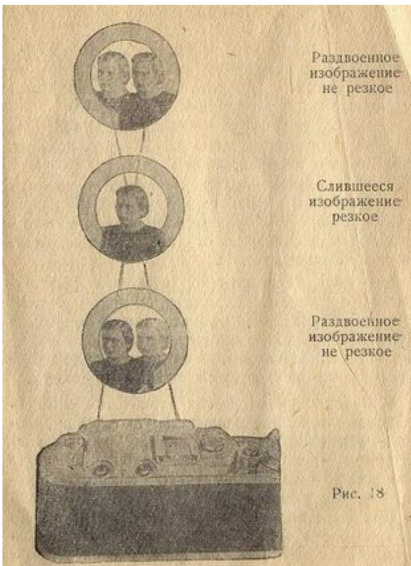
Après avoir sorti la bague de sa position de verrouillage tourner l'objectif à l'aide de cette bague en observant l'image dans le champ central (jaune) du télémètre (figure 18).
