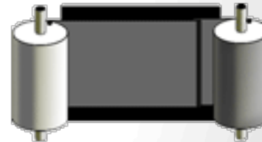
Fonctionnement de l'obturateur à rideaux VITESSES RAPIDES 1 - ARMEMENT
